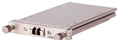
図15 100ギガビット/40ギガビットCFP光トランシーバモジュール
