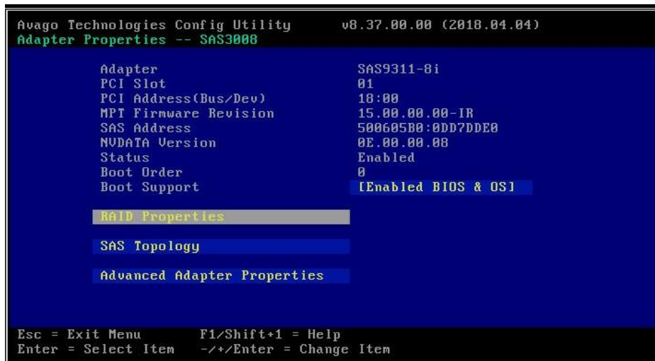
図56 RAID Propertiesを選択
