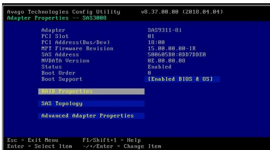
図45 RAID Propertiesを選択
