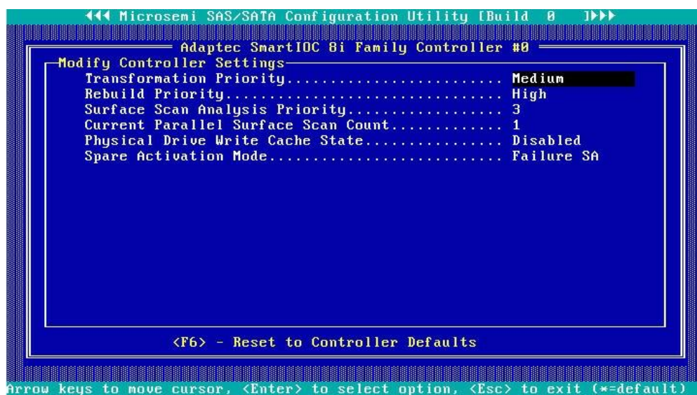
図78 コントローラー設定の変更画面
