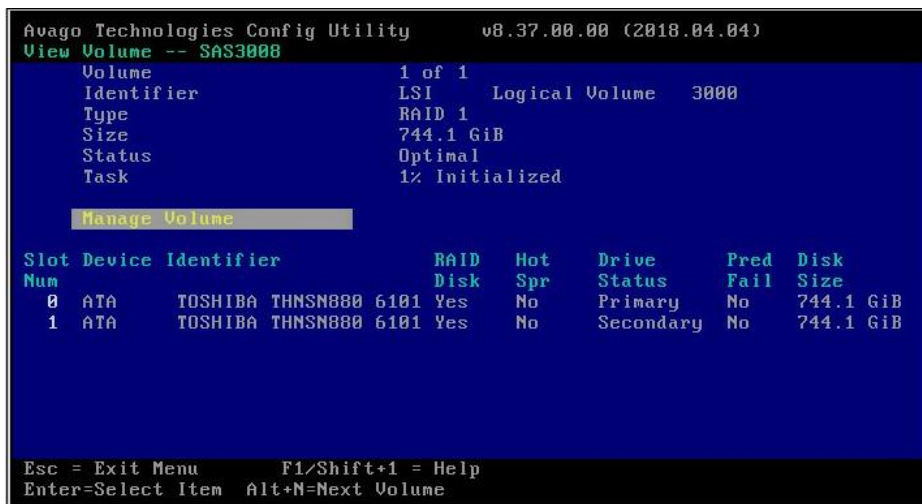
図57-1 Manage Volumeの選択
