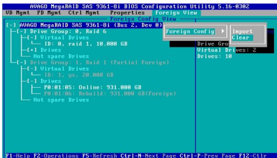
図150 Foreign Config > Clearの選択
