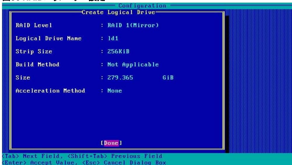
図56 RAIDパラメーター設定
