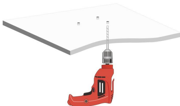
図2-10 天井タイルに穴を開ける
