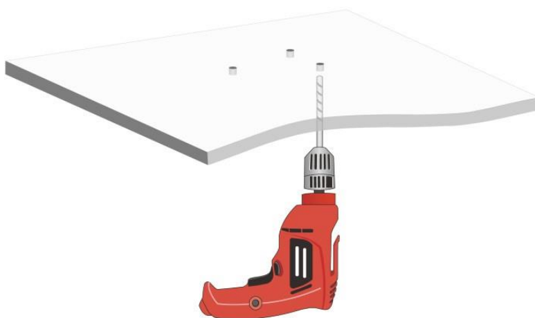
図4-9天井タイルへの穴あけ
