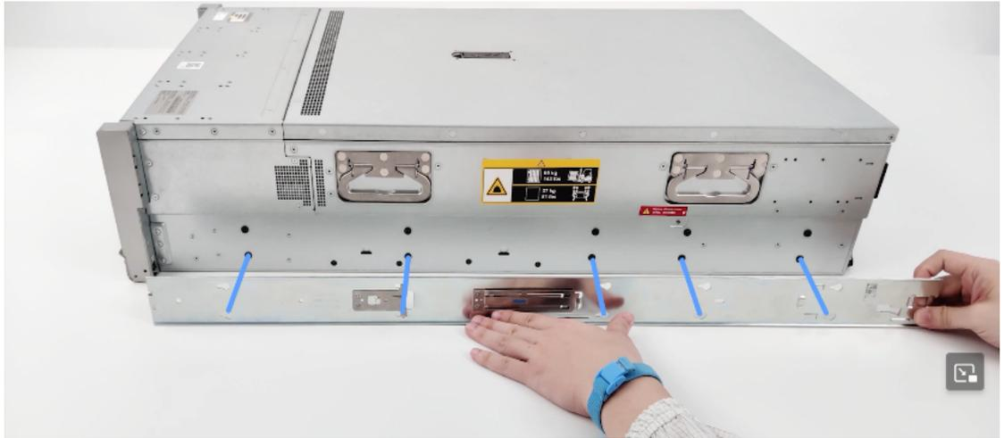
b. レールをトレイの後ろ方向にスライドさせて固定します。
