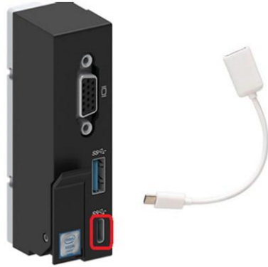
図64 G6サーバーのUSB Type-Cコネクタ
